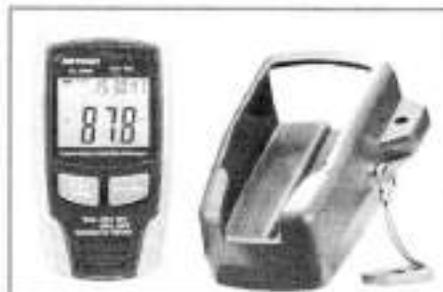
**Ubicación:** es importante situar los termohigrómetros por encima del nivel del suelo (*mínimo a 60 centímetros*), lejos de los respiraderos y de los equipos de calefacción, enfriamiento, humidificación y deshumidificación, así como de puertas y ventanas.
